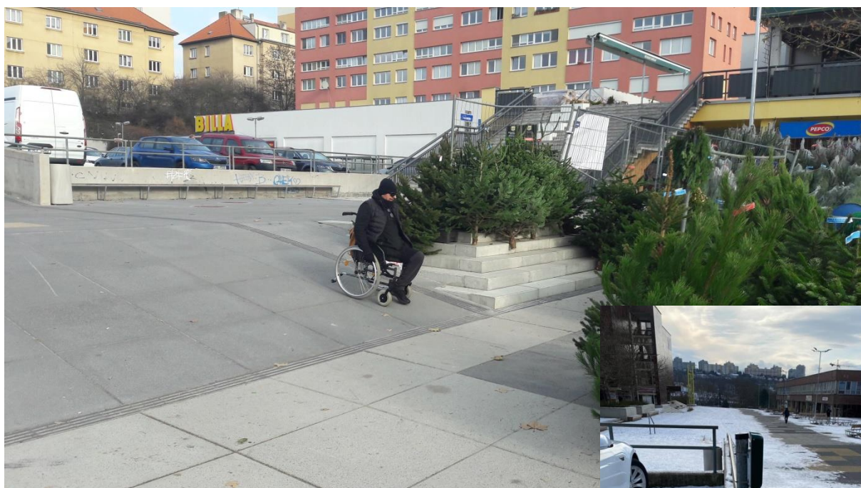
Sofijské náměstí – severní část, nebezpečný sklon rampy a piktogram se zákazem vstupu; zdroj: archiv NRZP ČR
